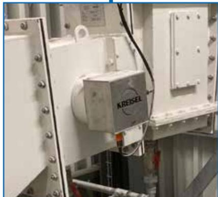
KREISEL Luftförderrinnen (AeroFeed) dienen dem staubfreien und energiearmen Transport fluidisierbarer Schüttgüter. Das Schüttgut wird auf einer Gewebbahn mittels eines Belüftungsventilators fluidisiert und aufgrund einer spezifischen Neigung der Luftförderrinne, die abhängig vom Schüttgut gewählt wird, transportiert.
