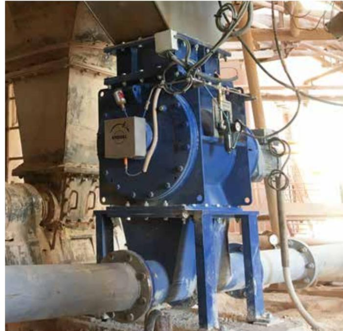
Pneumatische Förderanlagen von KREISEL dienen dem Transport von Schüttgütern jeglicher Art. Förderentfernungen von größer 1.000 m sowie Förderleistungen >200 t/h sind realisierbar. Jede Förderanlage wird auf die Kundenbedürfnisse energieoptimiert angepasst. Unterschiedliche Faktoren wie Förderleistungen, Schüttguteigenschaften und Förderentfernungen spielen eine zentrale Rolle für die richtige Wahl des entsprechenden Einschleusorgans.
